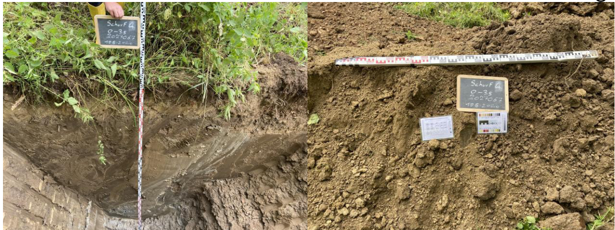
Abbildung 6: links: Baggerschurf 4, rechts: Aushubmaterial
