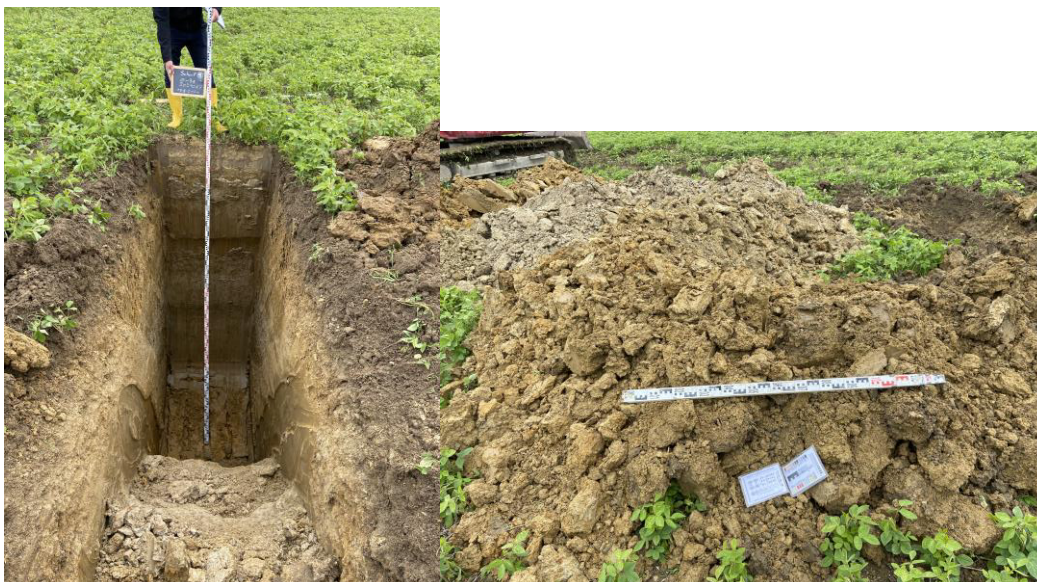
Abbildung 11: links: Baggerschurf 9, rechts: Aushubmaterial
