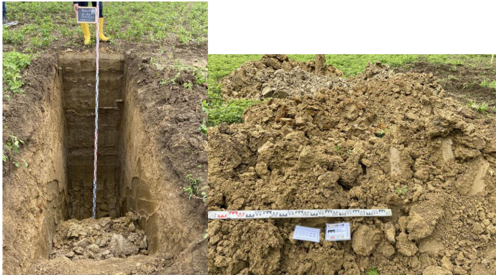
Abbildung 12: links: Baggerschurf 10, rechts: Aushubmaterial
