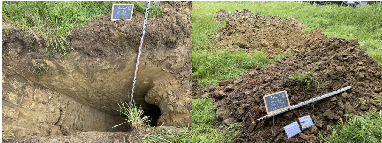
Abbildung 4: links: Baggerschurf 2, rechts: Aushubmaterial
