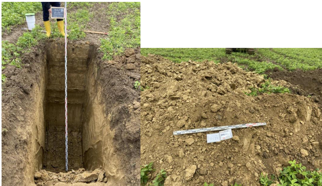
Abbildung 16: links: Baggerschurf 14, rechts: Aushubmaterial
